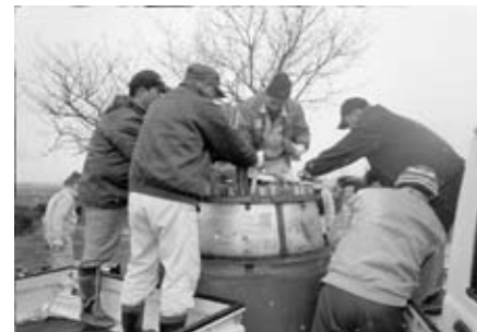
竹炭の製造（竹材の釜入れ）作業
